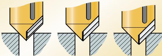
Lors de la descente de la broche, le cône pilote centre la pièce, coulisse jusqu'à la butée (écrou de réglage) et laisse sortir la lame.
