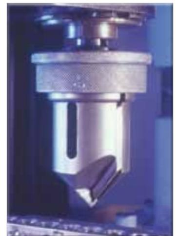
*Les Appareils à Chanfreiner KOPAL s'utilisent sur Machine à chanfreiner ou Perceuse à colonne à avance manuel.*
